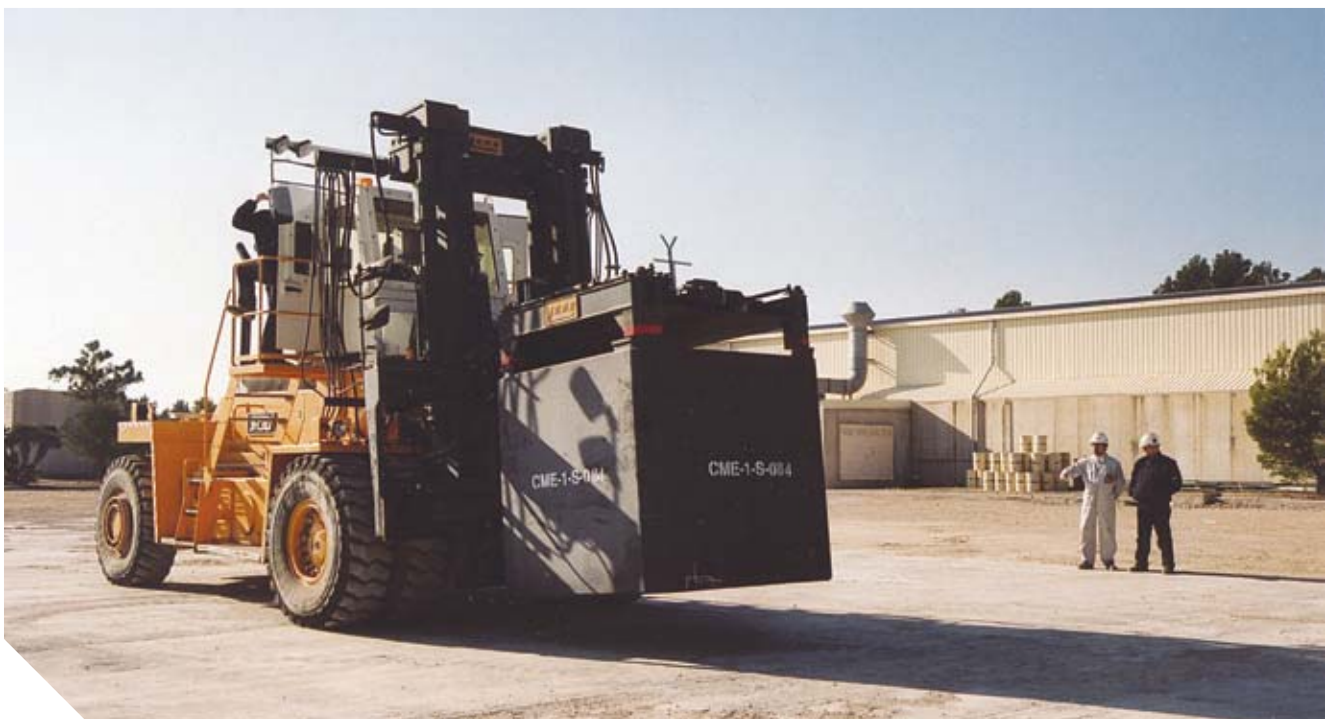
TRASLADO DEL GRAFITO RADIATIVO AL NUEVO DEPÓSITO TEMPORAL
