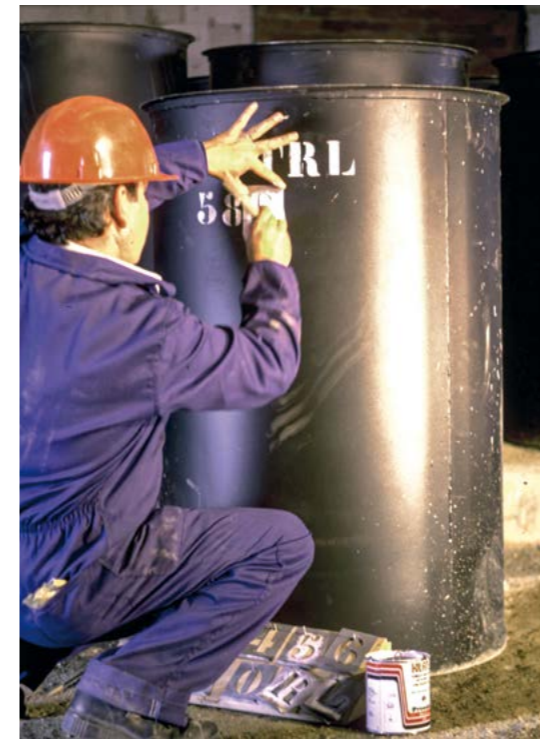
Etiquetado de los bultos para el reacondicionamiento de residuos de la Mina Beta.
