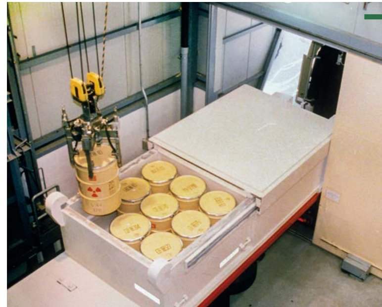
ENRESA TIPO XXVI Embalaje homologado como IP-2, utilizado para el transporte de residuos sólidos.
