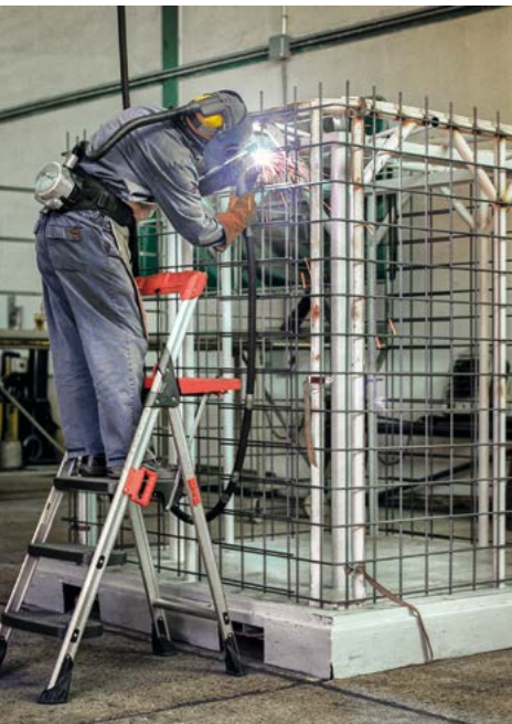
Trabajos de soldadura del armazón de un contenedor de almacenamiento de residuos radiactivos de baja actividad en El Cabril. Descarga de un transporte de residuos en esta misma instalación.
