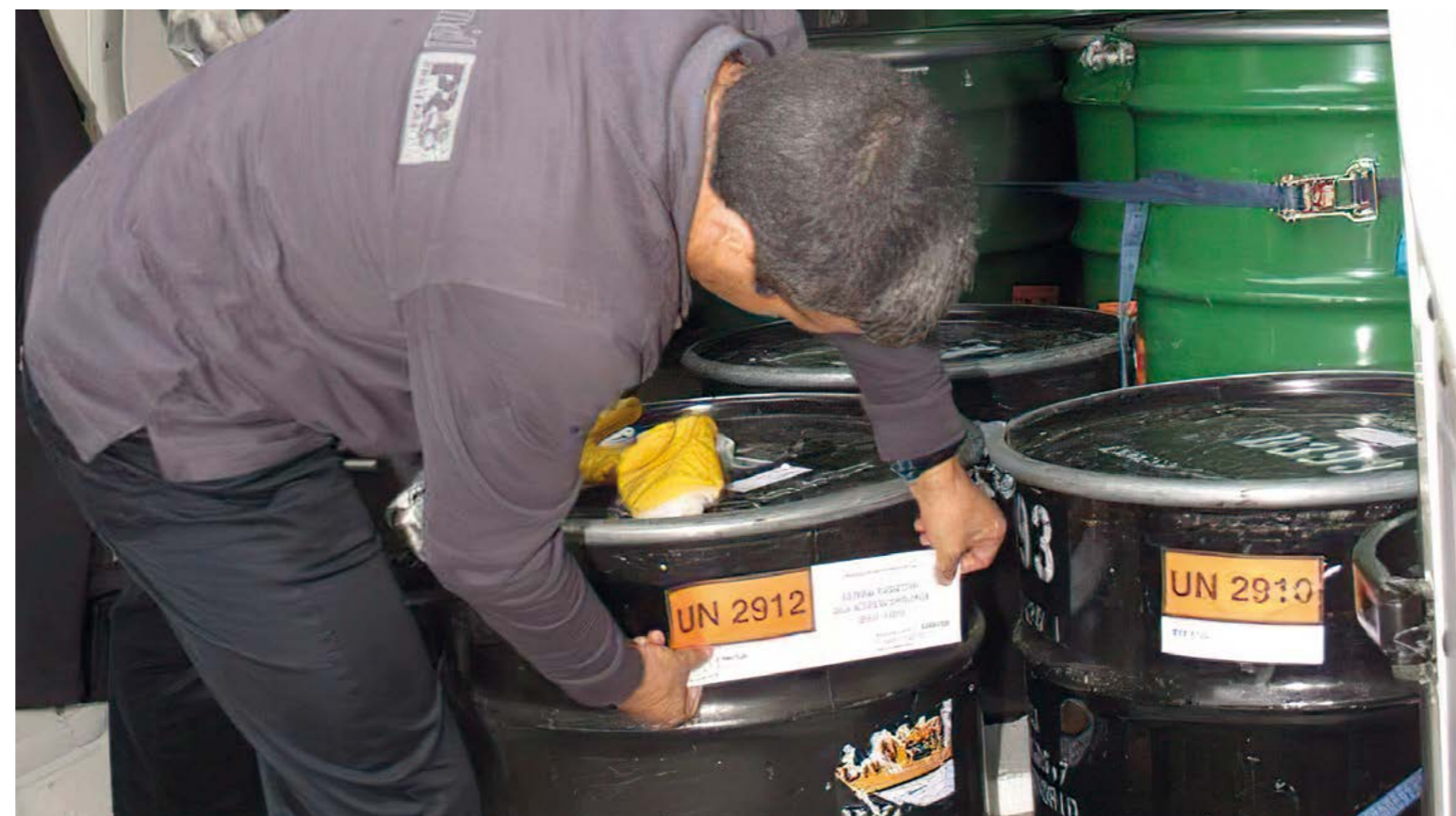
Retirada de residuos de baja y media actividad en una instalación radiactiva.
