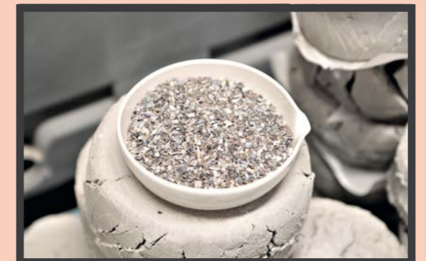
Detalle de áridos para hormigón hecho con concha de mejillón. Laboratorio de la ETS de Ingeniería de Caminos, Canales y Puertos de A Coruña.
