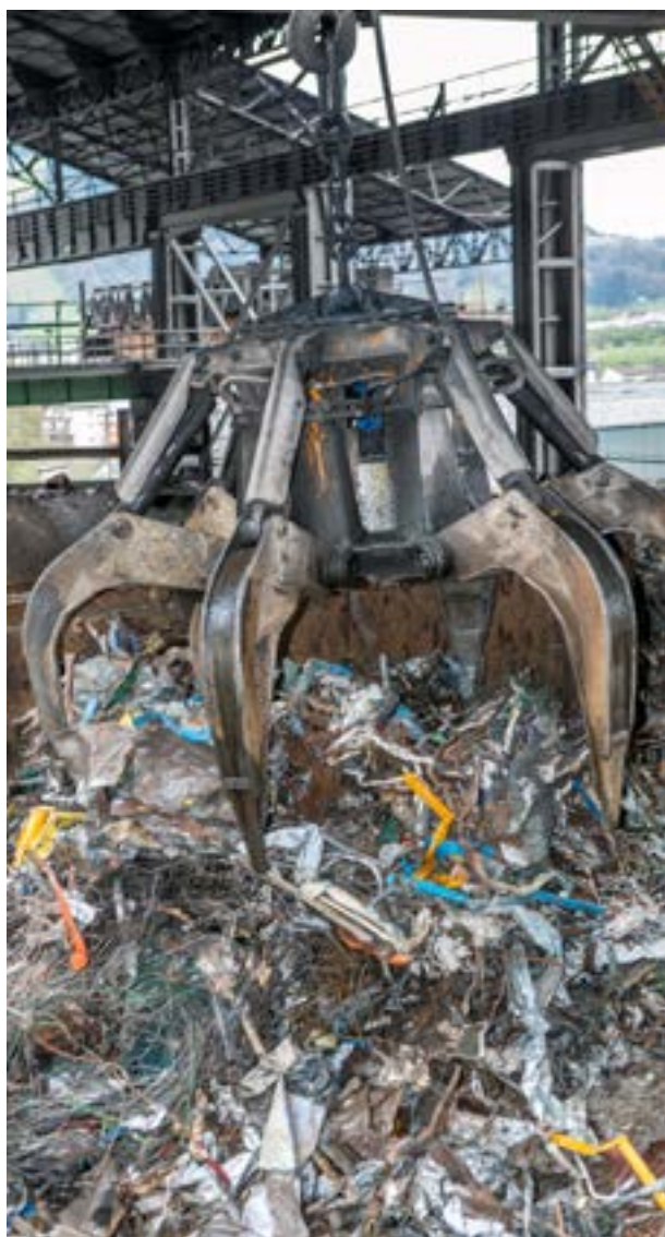
Procesado de chatarra de fundición en una instalación siderúrgica.
