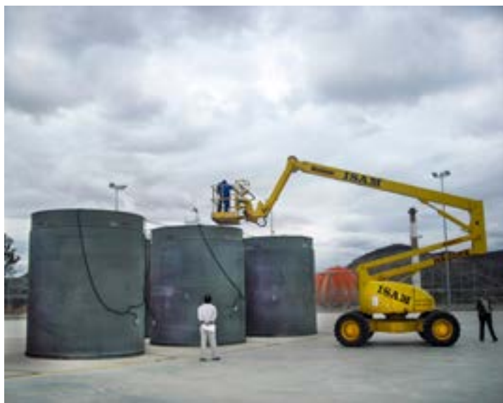
Inspección de salvaguardias en los contenedores de almacenamiento de residuos radiactivos de alta actividad en el ATI de la central nuclear José Cabrera. Archivo Enresa.
