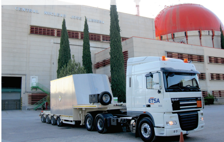
Equipo de transporte de contenedores de hormigón tipo CE-2a en la central nuclear José Cabrera.
