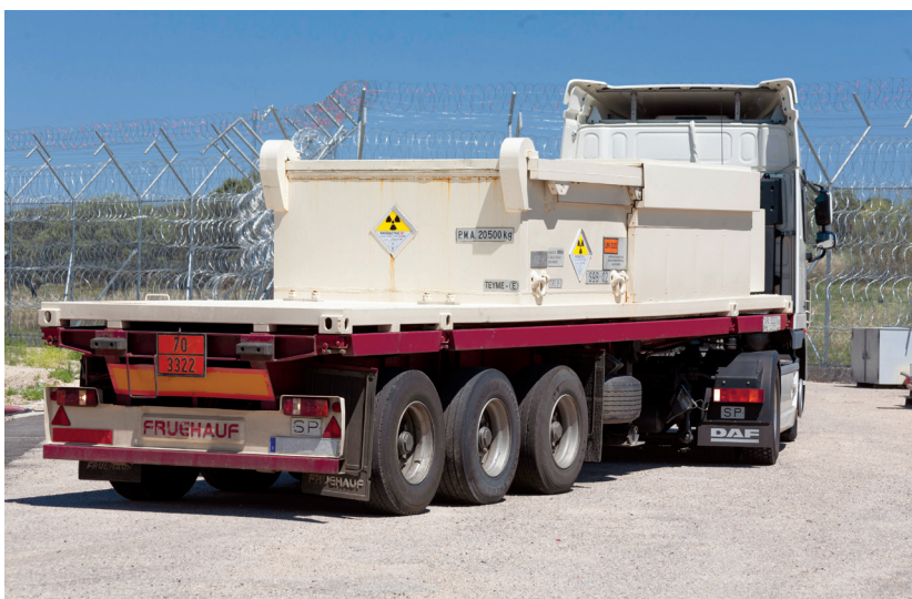
Equipo de transporte de 9 bidones irradiantes de RBMA (tasa de dosis en contacto inferior a 2 milisievert hora).
