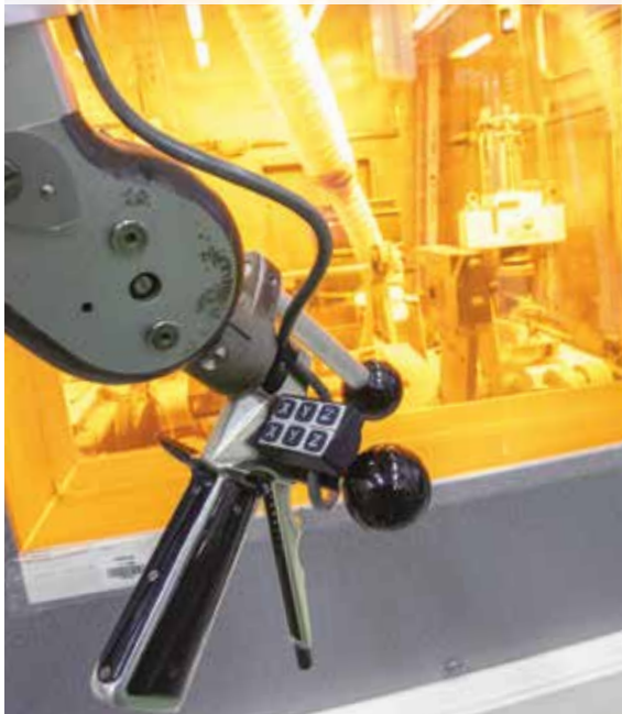
Telemanipuladores de la celda caliente. Laboratorio Activo.
