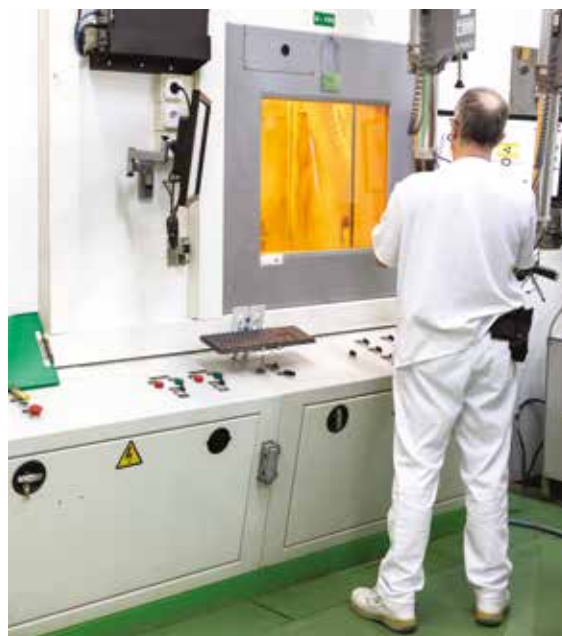
Laboratorio Activo del Centro de Almacenamiento de El Cabril. Trabajos con el telemando en la celda caliente.
