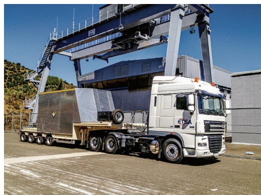
Equipo de transporte de contenedores de hormigón tipo CE-2a en El Cabril.
