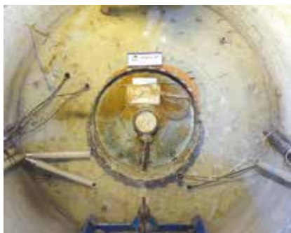
FIGURA 5. Aspecto de la barrera de bentonita en torno al calentador durante el montaje en 1997, en la que se observa la separación entre bloques y entre los bloques y el granito en la parte superior de la galería (arriba) y de su estado durante el desmantelamiento en 2015, con las juntas entre bloques selladas y apenas visibles (abajo).
