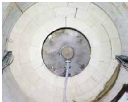
FIGURA 5. Aspecto de la barrera de bentonita en torno al calentador durante el montaje en 1997, en la que se observa la separación entre bloques y entre los bloques y el granito en la parte superior de la galería (arriba) y de su estado durante el desmantelamiento en 2015, con las juntas entre bloques selladas y apenas visibles (abajo).
