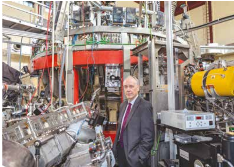
Carlos Alejaldre, responsable científico de la candidatura española del IFMIF-DONES , ante el TJ2, un stellerator flexible que es el buque insignia del Laboratorio Nacional de Fusión.
