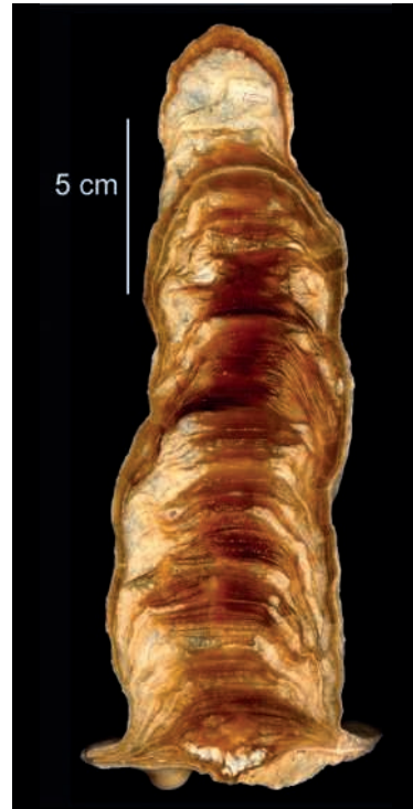
Sección longitudinal de una estalagmita en la que se aprecia su estratigrafía interna. Este tipo de muestra se usa para la reconstrucción de series de parámetros climáticos a partir de la identificación, a lo largo del eje de crecimiento, de cambios composicionales o texturales relacionados con los cambios climáticos. Esta estalagmita está expuesta en el Centro de Visitantes del Monumento Natural de Ojo Guareña (Burgos)
