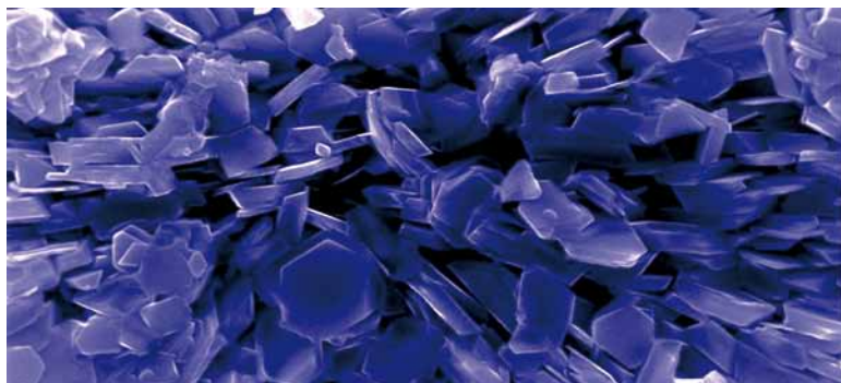
Nanoestructuras formadas por la oxidación húmeda en agua con cloruro de zinc
