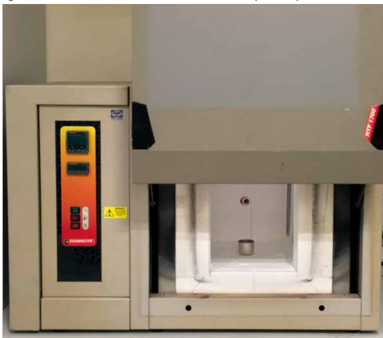
Figura 4: Calentamiento a 900 °C de la mezcla de Na-Mica-4 en pocillo de platino.
