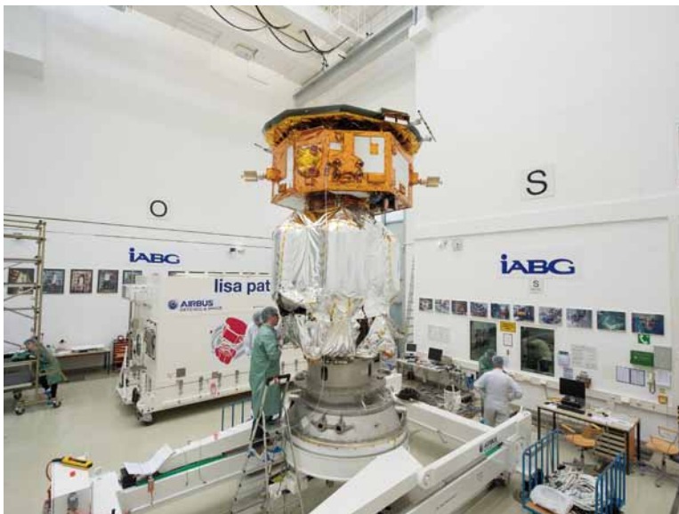
Montaje de las piezas de la sonda en una sala blanca.
