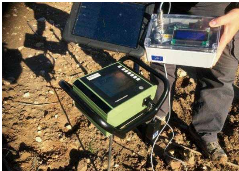
Para los análisis se emplearon un rhoc, que mide la densidad total aparente del suelo, y un penetrómetro, que determina la profundidad de las raíces del suelo.
