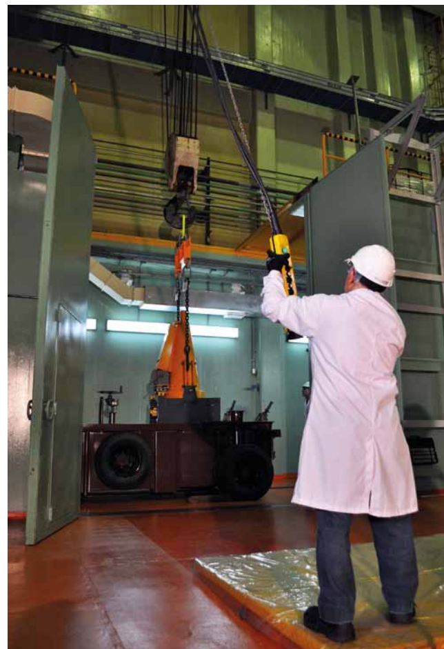
Manejo de combustible gastado en la instalación de Almacenamiento de Combustibles Irradiados de Reactores de Investigación (FACIRI).
