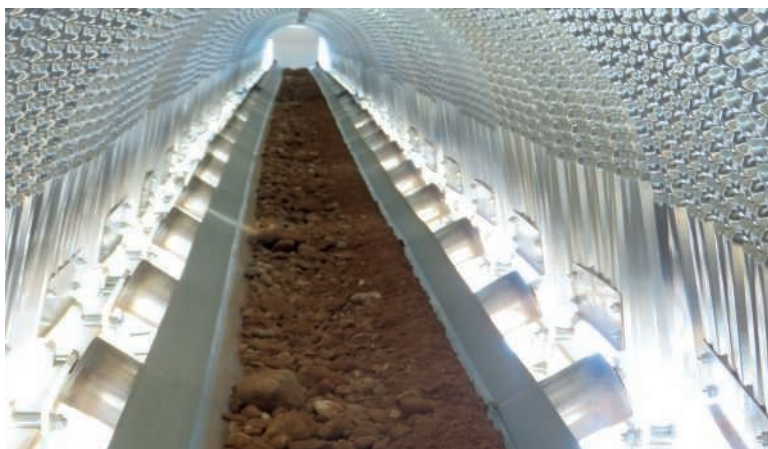
Alimentación de material. Previamente, se separa el material de tamaño superior a 100 mm, en la zona de acopio de entrada. Posteriormente, se aporta el material en la tolva de la plataforma de carga.
