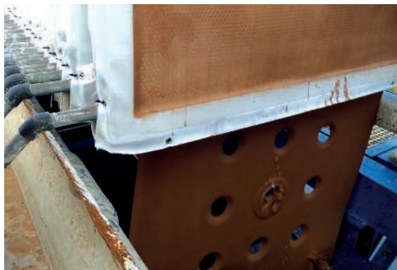
Etapa de filtración. La etapa de filtración se realiza mediante un filtro-prensa en el cual se consigue concentrar todo el material fino compactado en condiciones adecuadas ("tortas").
