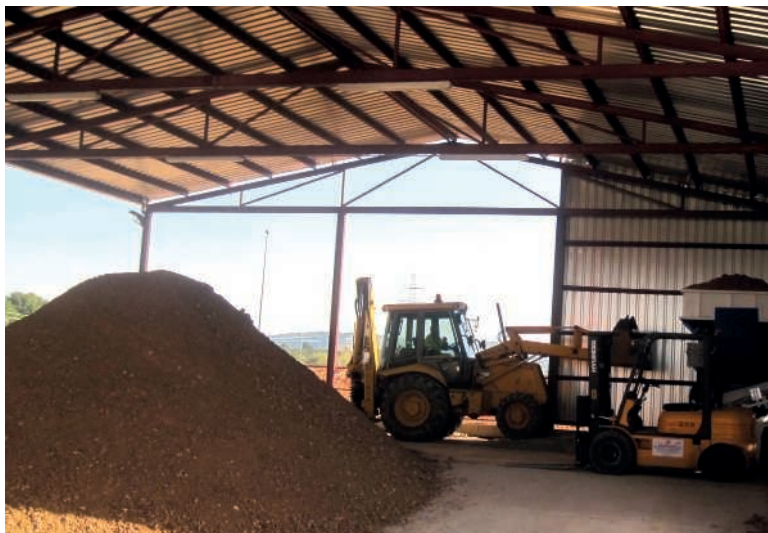
Alimentación de material. Previamente, se separa el material de tamaño superior a 100 mm, en la zona de acopio de entrada. Posteriormente, se aporta el material en la tolva de la plataforma de carga.
