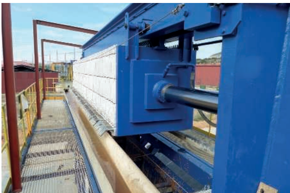
Etapa de filtración. La etapa de filtración se realiza mediante un filtro-prensa en el cual se consigue concentrar todo el material fino compactado en condiciones adecuadas ("tortas").
