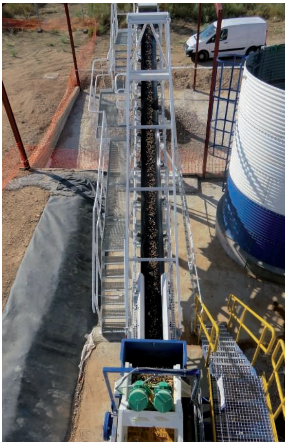
Línea lavado de gravas. Las gravas se lavan en una rampa y se pasan por un escurridor vibrante. Desde este punto, se conducen mediante una cinta transportadora hasta el acopio de gravas desclasificables.
