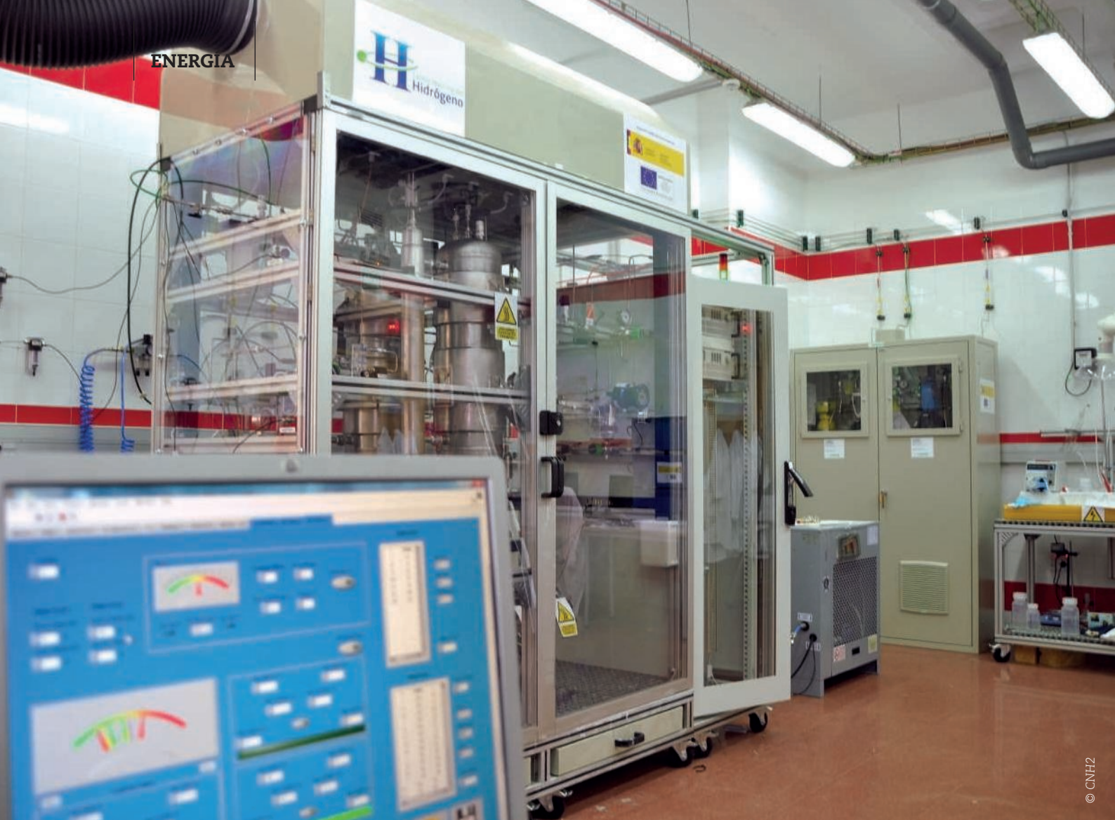
Instalación del Centro Nacional de Hidrógeno (CNH2) donde se realizan ensayos de caracterización a electrolizadores y pilas de combustible.
