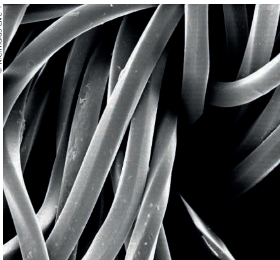
Observación de poliamida por un análisis de tipo SEM, microscopía electrónica de barrido.
