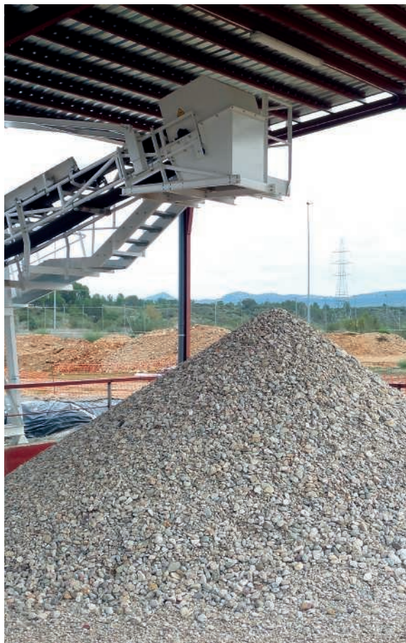
Línea lavado de gravas. Las gravas se lavan en una rampa y se pasan por un escurridor vibrante. Desde este punto, se conducen mediante una cinta transportadora hasta el acopio de gravas desclasificables.
