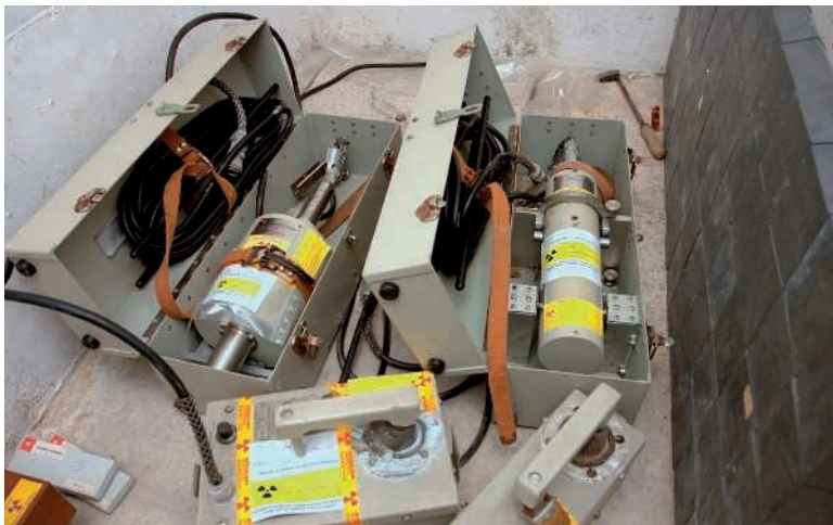
Retirada de fuentes radiactivas.
