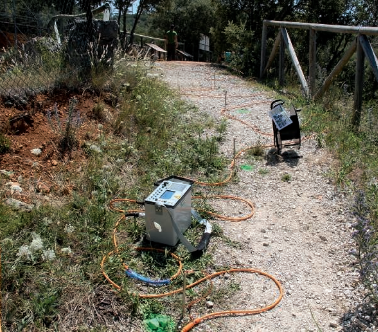
Mediante la Tomografía de Resistividad Eléctrica se han determinado la extensión, profundidad y dirección de los yacimientos de Gran Dolina y Complejo Galería en Atapuerca.
