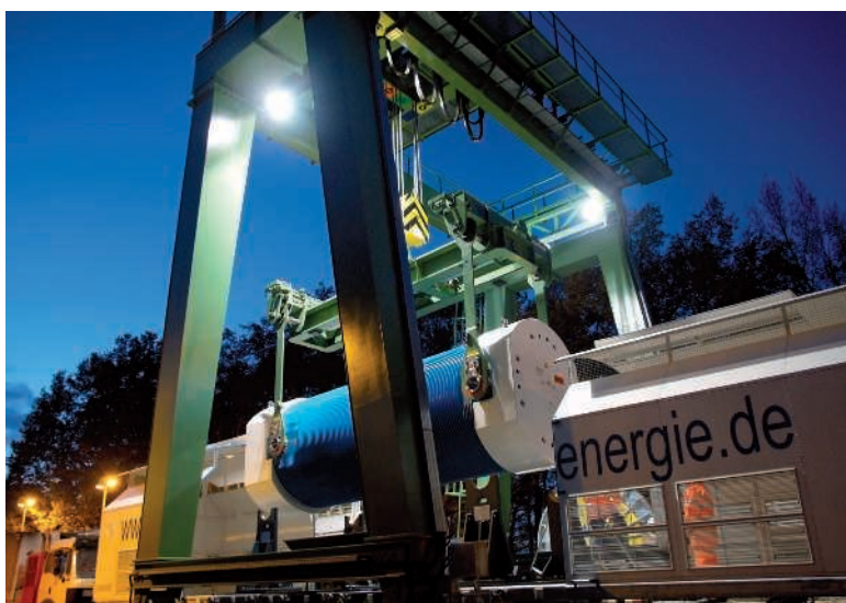
Transporte de un contenedor de combustible gastado
