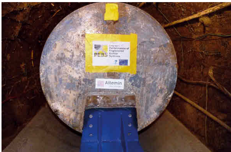
Experimento EB tal y como ha quedado tras su desmantelamiento.
