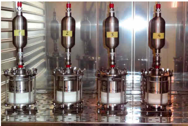
Conjunto de celdas de experimentación de la UAM. Montaje que ha servido para simular el estado de la barrera de bentonita de un repositorio de entre 1.000 y 3.000 años de evolución.
