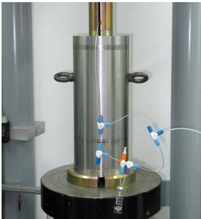
Componentes de las prensas para la extracción del agua intersticial por squeezing (500 y 250 mm de longitud y 45 mm de espesor).
