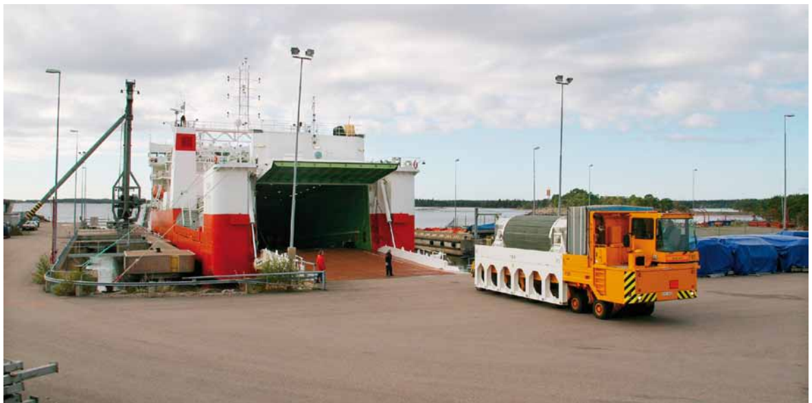
Transporte de combustible nuclear gastado desde el barco Sigyn al CLAB en Oskarshamn.
