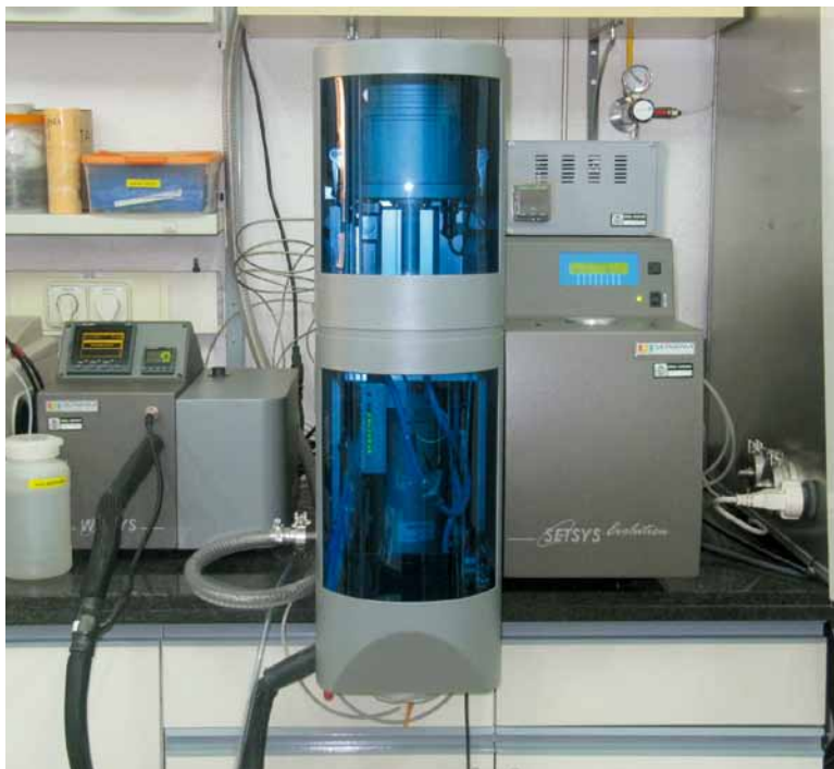
Equipo de análisis termogravimétrico y calorimetría diferencial de barrido (TG-DSC) acoplado al equipo WETSYS.
