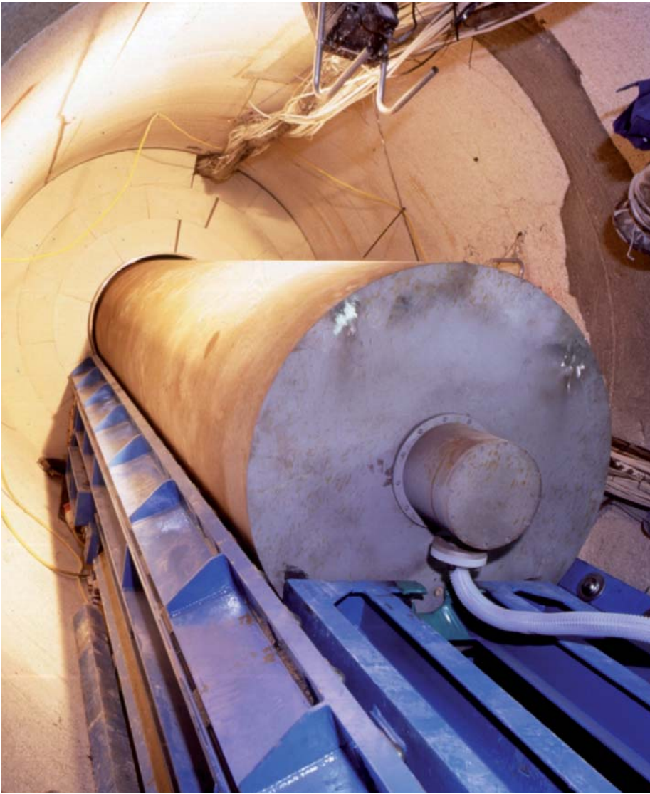
Experimento Febex in situ. Calentador eléctrico que simula un contenedor de combustible gastado.
