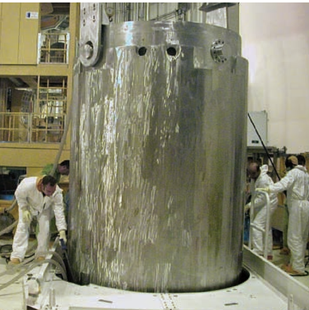
Manipulado de un contenedor de residuos radiactivos de alta actividad.
