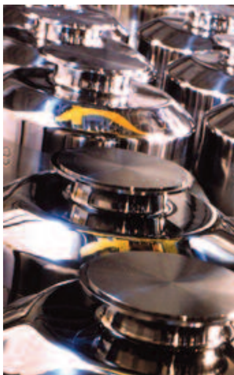
Planta Thorp, donde se reprocesan combustibles gastados de tipo óxido. A la izquierda, contenedores para el almacenamiento de residuos vitrificados.
