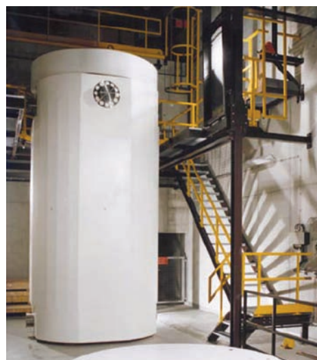
Almacenamiento de combustible gastado en contenedor en la central nuclear de Doel. A la derecha, bóveda del ATC de Dessel destinada al almacenamiento de vidrios procedentes del reproceso en la planta de Eurochemic.
