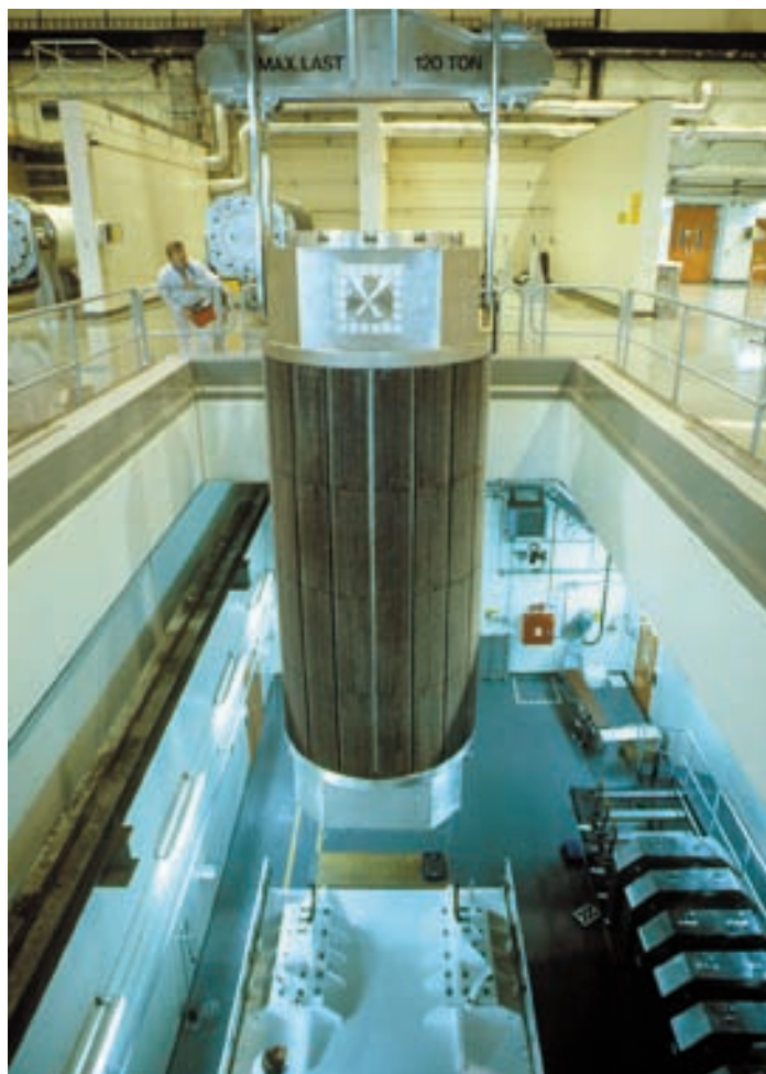
Arriba a la izquierda, vista panorámica de la instalación CLAB, el ATC de Suecia, ubicado en el emplazamiento de la central nuclear de Oskarshamn. A la izquierda, la piscina para la transferencia de elementos a las cápsulas de almacenamiento. Sobre estas líneas, una cápsula preparada para ser trasladada a la piscina de almacenaje.
