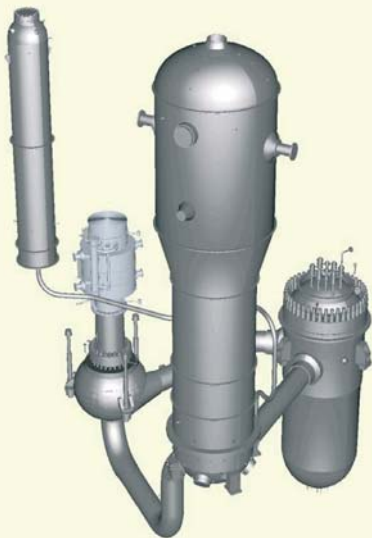
Sistema de generación de vapor de la central nuclear José Cabrera.
