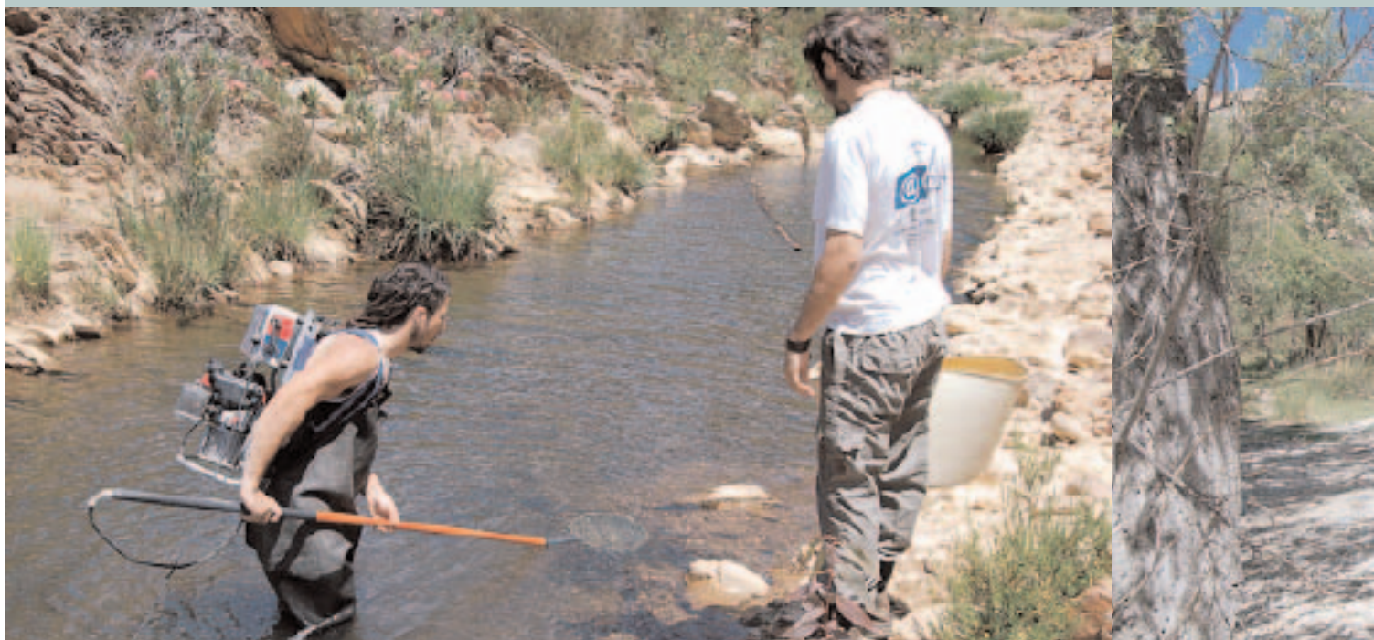
La pesca eléctrica es el método utilizado en los muestreos que se están llevando a cabo. Los ejemplares quedan electronarcotizados y pueden ser capturados fácilmente, medidos, examinados y liberados de nuevo sin daño alguno.
