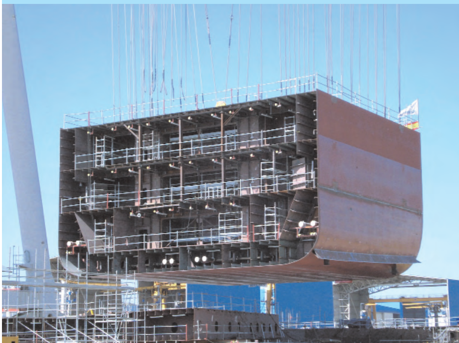
El Buque de Aprovisionamiento en Combate (BAC) Cantabria dispondrá de doble casco en la zona de tanques, para evitar catástrofes como la del Prestige .
