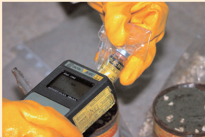
Medición de actividad de una fuente radiactiva.
