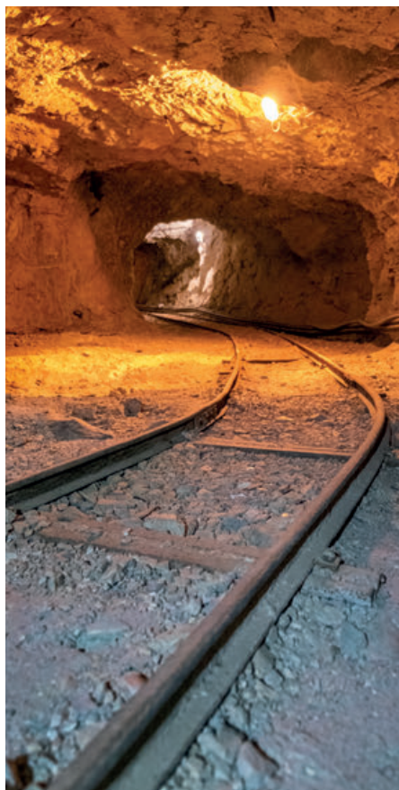
Por sus buenas condiciones de estabilidad y estanqueidad, la mina Beta fue escogida por la JEN como primer almacén de residuos
