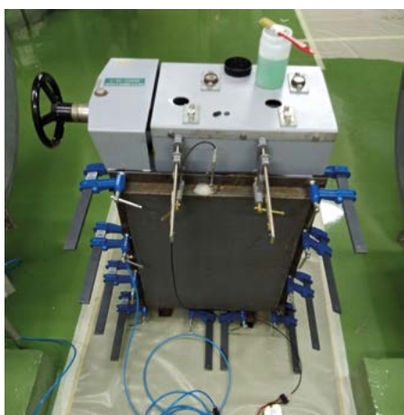
Prueba de estanqueidad de compuertas de ventilación controlada
