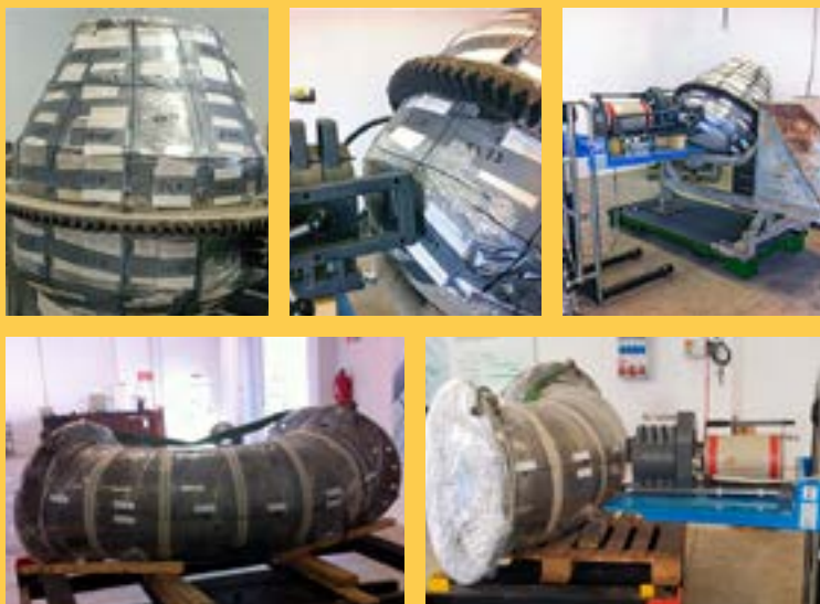
Medición de piezas de geometría compleja conjuntamente con detectores con y sin capacidad espectrométrica.
