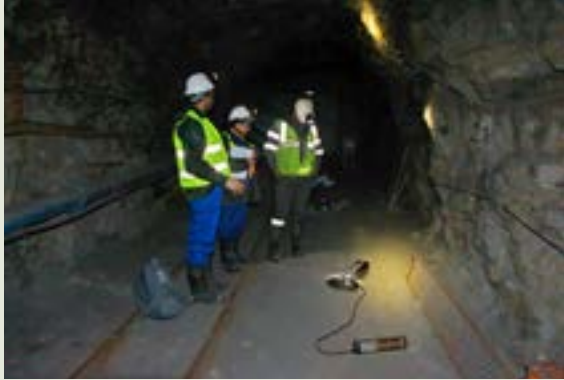
Ensayo del prototipo TTE en mina de El Bierzo (España), a la derecha el transmisor y a la izquierda el receptor.
