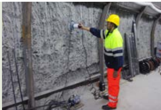
Ensayo del prototipo TTE en el Laboratorio Subterráneo de Tournemire (Francia), a la izquierda se observa la distancia entre el transmisor y el receptor.
