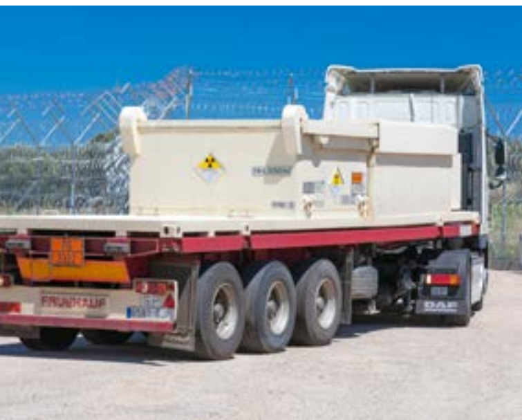
Contenedor de transporte de residuos radiactivos de baja y media actividad a El Cabril.
