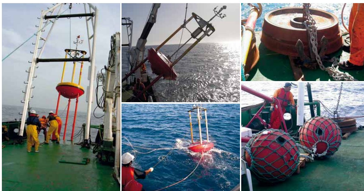
Fases de la operación que se lleva a cabo en la cubierta del buque para ubicar las boyas en el mar, y (fotos de la derecha) elemento para anclarla al fondo marino y flotadores sumergibles para que conserven la verticalidad.
