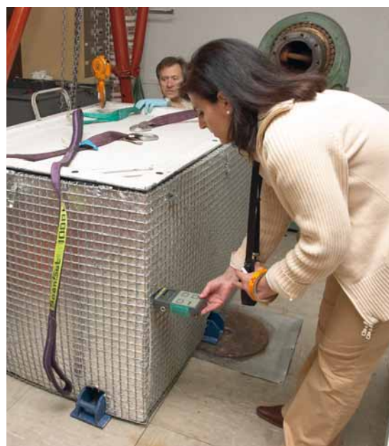
Medición de tasa de dosis de una fuente acondicionada para su retirada.
