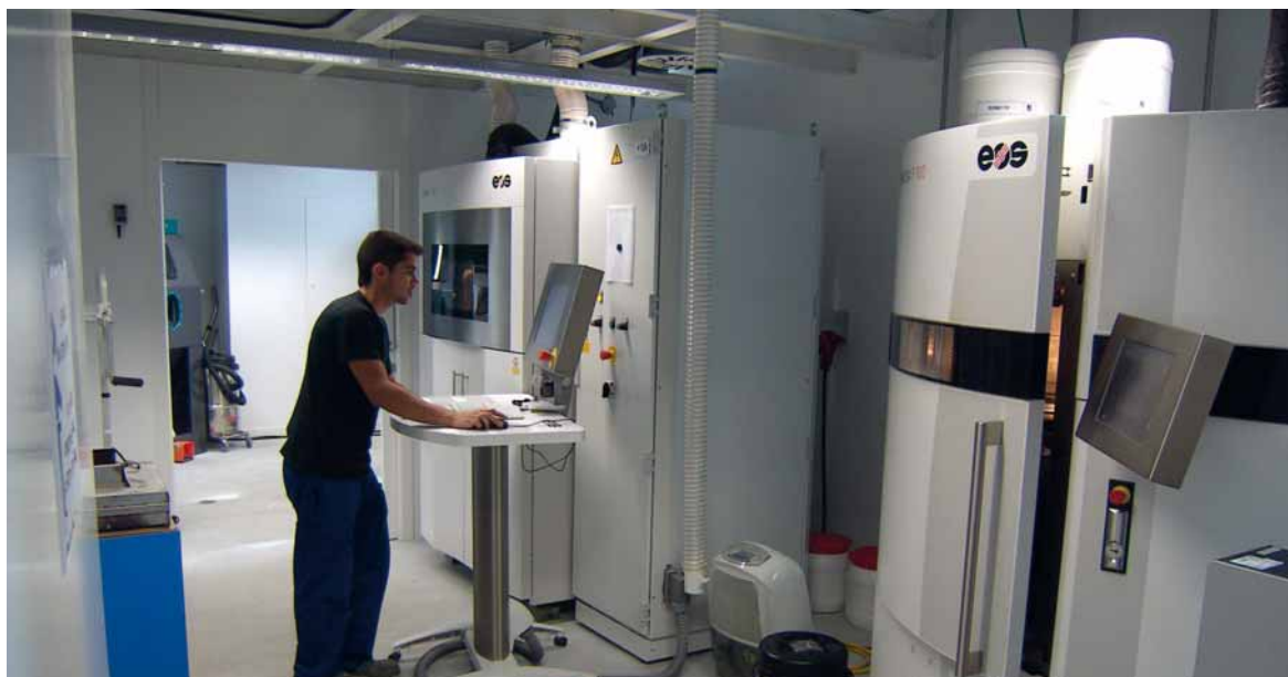
Operario de la Fundación Prodiotec trabajando con un equipo AM de poliamida.
