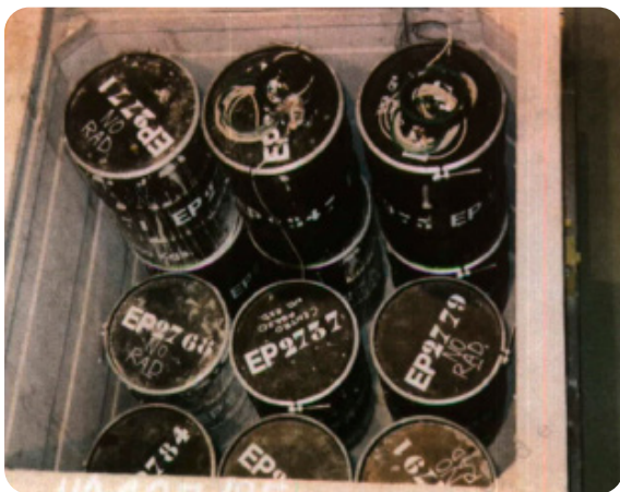
Figura 5-32: Armadura del contenedor instrumentado y cableado de sensores, esquema con la distribución de sensores en el contenedor (arriba); distribución bidones instrumentados en el interior del contenedor; esquema de sensores en los bidones (abajo)
