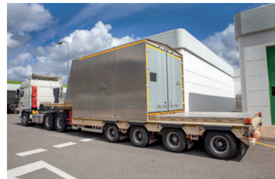
Transporte RBMA - Vehículo - góndola para transporte de contenedores tipo CE-2a y CE-2b en El Cabril
